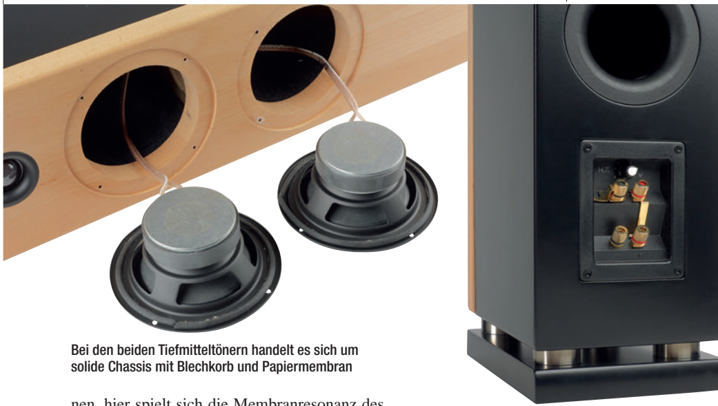
Mit den beiden Brücken lässt sich der Pegel des Mitteltöners einstellen sowie sein Übergang zum Hochtöner beeinflussen
